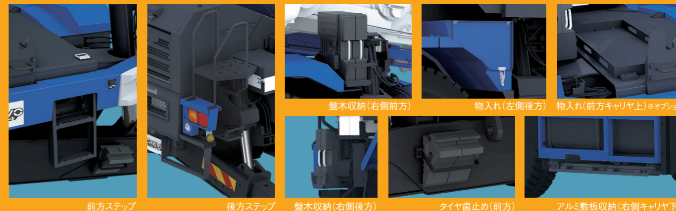
前方ステップ 後方ステップ 盤木収納(右側前方) 物入れ(左側後方) 物入れ(前方キャリア上)※オプション 盤木収納(右側後方) タイヤ歯止め(前方) アルミ敷板収納(右側キャリア下)
